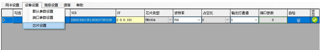
3. “芯片设置”界面读取并显示控制器原配置芯片，用户点击【芯片类型】下拉选项进行选择（最多 32 项）。
