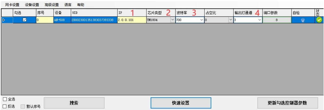
默认参数设置：点击【快速设置】后，如下图依次设置参数，再依次点击【默认勾选控制器参数】、【保存并退出】、【更新勾选控制器参数】。
