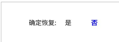
3. 确认是否需要恢复出厂设置，点按【ENTER】以确认更改，液晶屏显示跳回参数界面。此时，所有设置的参数会变成出厂状态。
